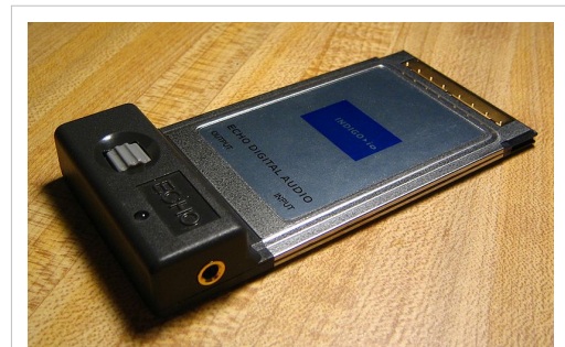
Indigo IO PCMCIA de 24 bits y 96 kHz estéreo fabricada por Echo Digital Audio Corporation
