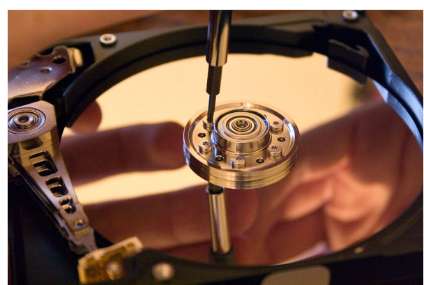
Interior de un disco duro; se aprecia la superficie de un plato y el cabezal de lectura/escritura retraído, a la izquierda.
