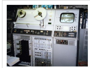
Magnetoscópio Ampex VRX2000 uno de los primeros modelos que grababan con cinta video magnética para la industria televisiva en blanco y negro(VTR).
