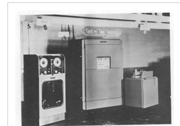
1955 Tape-to-Card Converter Primer convertidor de cinta a tarjeta, usaba formato de cinta Uniservo fabricado por Remington Rand para computadora Univac
