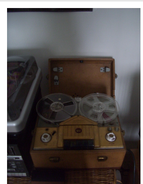
Grabadora Magnética Estadounidense modelo Wilcox-Gay de riel o bobina grababa audio en las primeras cintas magnéticas de celulosa y acetato producidas en EU equipo producido entre 1940 y 1950.
