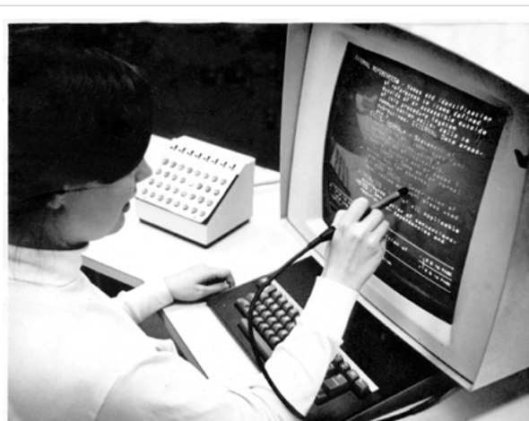
Foto de la consola del Hypertext Editing System (HES) en uso en la Universidad Brown, cerca de octubre de 1969. La foto muestra al HES en una estación de exhibición IBM 2250 Mod 4, incluyendo el lightpen y el teclado de función programada, el canal acoplado a la unidad central del IBM 360 de Brown.
